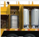
Cj. Depósitos presurizados 250L, para aceites lubricantes, fabricados según Normas ASME y NR13 y cj. descarga con carretes retráctiles y mangueras Ø 1/2" x 15 m con picos suministradores.
